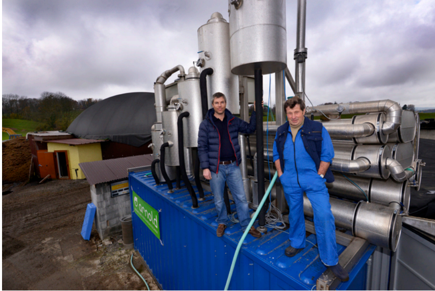
Oliver Arnold et Georges Martin sur le prototype, pour l'instant unique en Suisse, qui sèche le digestat liquide. Image: PATRICK MARTIN
